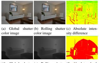
(d) Global shutter (e) Rolling shutter (f) Absolute depth depth image depth image difference
